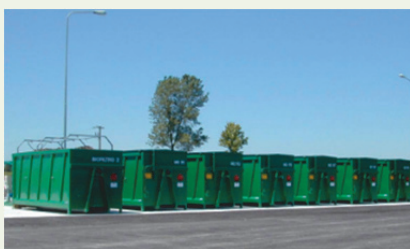
Container κομποστοποίησης με τυποποιημένες διαστάσεις και ενσωματωμένο σύστημα αερισμού, ύγρανσης και ελέγχου.
